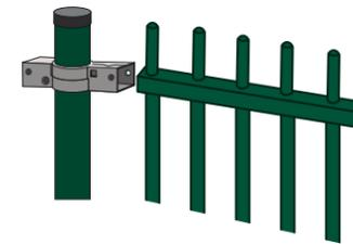
4/ Colocar el bastidor, asegurándonos de encajarlo dentro de las abrazaderas.
