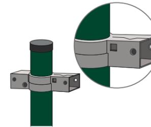
3/ Montar la abrazadera metálica en el poste (4 unidades por poste).
