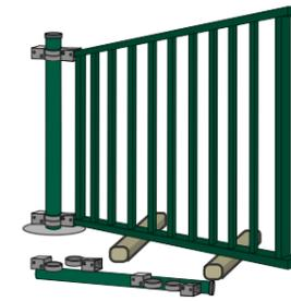
5/ Cimentar el siguiente poste y encajar el panel en las abrazaderas. Atornillar las 4 abrazaderas al bastidor.
