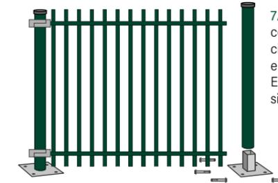
7/ Si se opta por el anclaje con placa base en lugar de cimentación, atornillar la base e insertar el primer poste. Enganchar el panel y colocar el siguiente poste.
